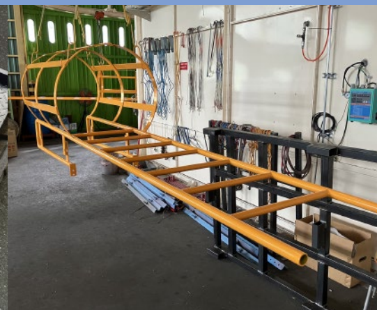
設備点検梯子
